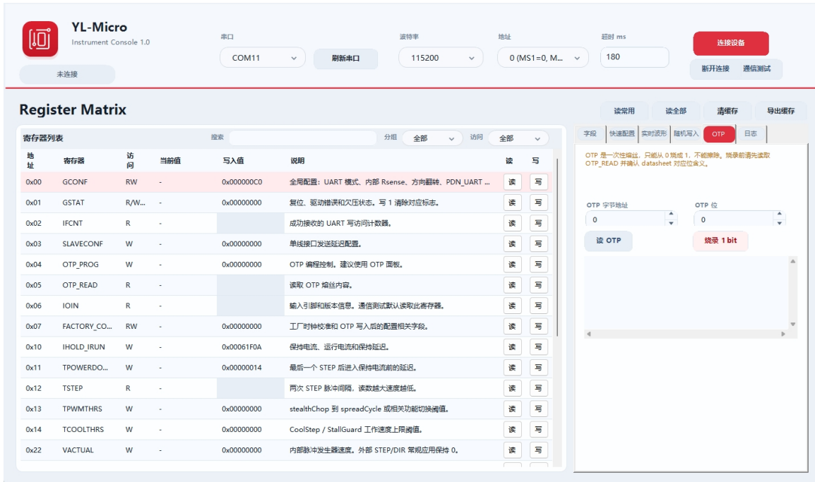
图 6 OTP：读取 OTP 内容并按 byte/bit 执行一次性烧录
